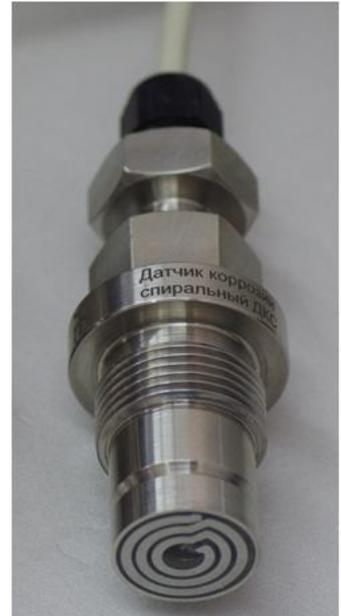
Рис.3 Установка для проведения испытаний в сероводородсодержащих средах, внешний вид спирального датчика коррозии
