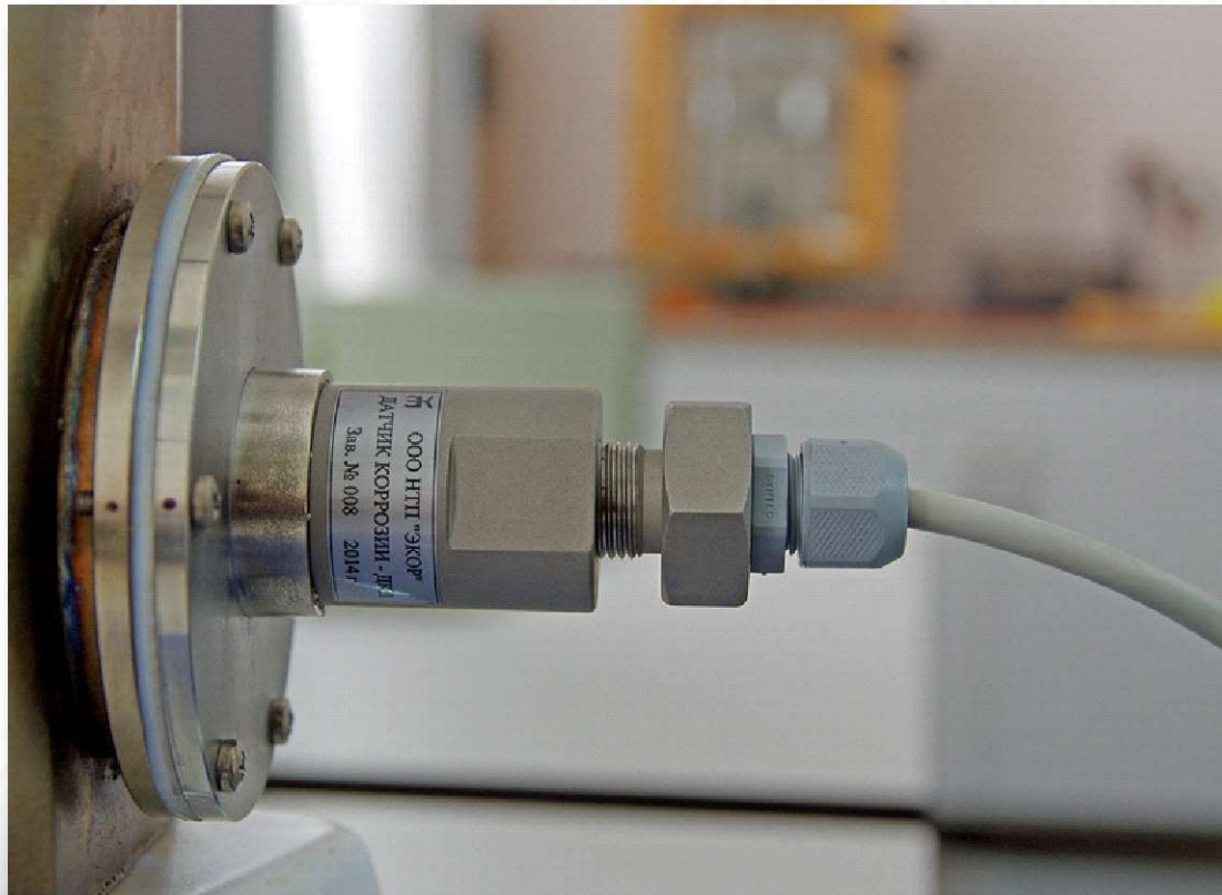
Внешний вид датчика коррозии, установленного на оборудовании
